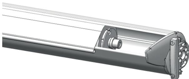
**Paso 4.** Montar el conjunto máquina-cassette-tapa del lado correspondiente.
