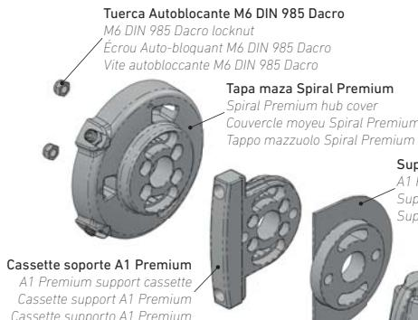
**7.** **Pour A1 Premium.** Visser les moyeux aux supports axe-toile, et au treuil ou moteur. Les moyeux ne peuvent être vissé que d'un seul côté (clé Allen de 5 mm)
